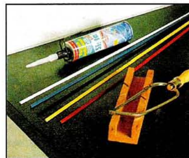
Для приклейки узких валиков-накладок требуется очень маленькое отверстие в насадке картриджа с герметиком, чтобы силикон не выдавливался по бокам.
