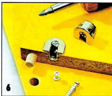
6 Во врезанном корпусе стяжки находится эксцентрик, который цепляется за головку ввернутого винта. Шкант служит направляющей.
