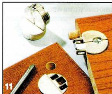
11 С этой фурнитурой очень легко работать благодаря ее конструкции. Части сначала соединяют свободно, а соединения затягивают лишь тогда, когда все крепежные элементы встали на место.
