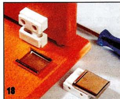
Корпусная стяжка состоит из двух пластиковых элементов, привернутых к деталям шурупами и соединяющихся друг с другом металлической крышкой.
