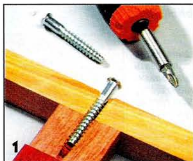
1 Ступенчатые мебельные шурупы. Резьба с большим шагом имеет высокую прочность сцепления, гладкий хвостовик помогает туго стянуть и точно зафиксировать детали. У потайной головки крестообразный шлиц.
