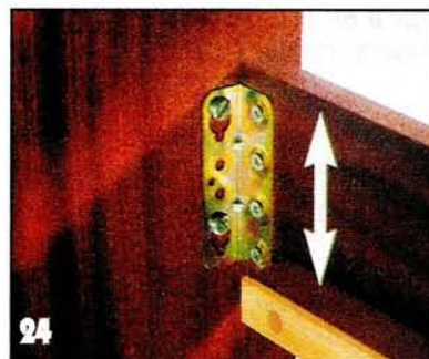
Универсальная «кроватьная» фурнитура. Рассчитана и на правую, и на левую боковины. Насаживается на шурупы с большими, плоскими снизу головками.
