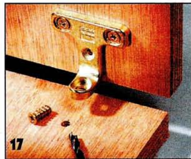
Пазы-отверстия этого уголка позволяют регулировать его положение. Как и евроуголок, это крепление соответствует европерфорации (система «32»).
