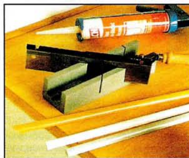
Пластиковый четвертной валик обрезают в стусле мелкозубой пилой. В угол наносят силиконовый герметик и «сажают» на него валик.
