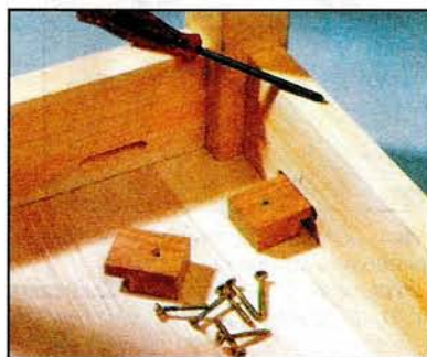
Сдвоенная «кроватьная» фурнитура. Если у кровати две сетки, между спинками необходима промежуточная балка, для крепления которой служит эта фурнитура.
