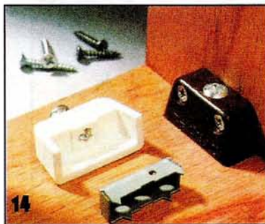
Трапециевидные уголки. Нижнюю металлическую часть и верхнюю пластиковую приворачивают шурупами каждую к своей детали, а затем насаживают друг на друга и фиксируют отдельным стопорным винтом.
