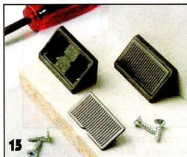
Уголки такой конструкции приворачивают к каждой детали соединения двумя шурупами. Недостаток — многократная сборка и разборка мебели портит резьбу в древесине.
