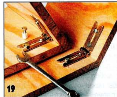
Шарнирный уголок позволяет соединять детали под углом от 30° до 270°. Если угол между соединяемыми деталями не позволяет применить шурупы, можно использовать забивные втулки и винты с шестигранной головкой под ключ.
