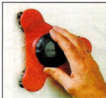
Так называемый «обойный тигр» вгрызается своими шипованными колесиками в обои, оставляя на них множество мелких отверстий.
